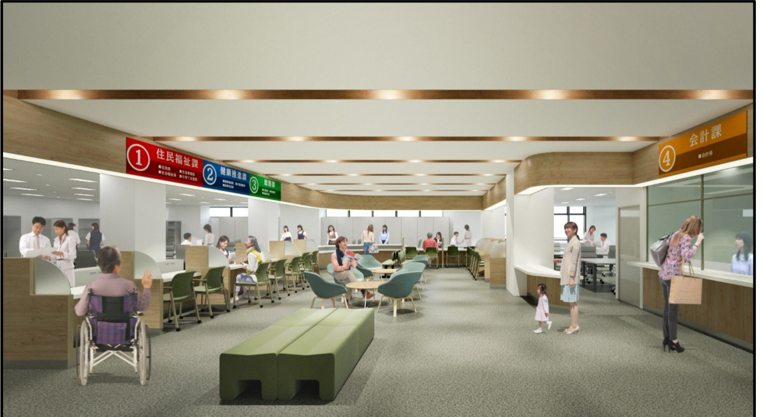
↑1階待合室・執務室 正面玄関からロビーを通り、右手すぐが待合室となる。受付カウンターをコの字に配置し、来庁者の方が目的の窓口がわかりやすい様にする。 窓口の案内サインは、色分けを行い、ロビーに設置する総合案内サインも同じ色分けとする。
